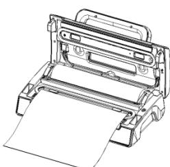
Asegúrese de que el extremo abierto de la bolsa se encuentra dentro de la cámara de vacío.
