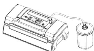
Vul het te vacumeren product in de bak. Let erop dat de bak niet te vol is. Sluit het deksel.
