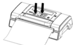
Pressez « **Vide/Scellage** » (Vakuum & Schweißen/Abbrechen). L'écran fait le compte à rebours jusqu'à 0 et l'air est aspiré automatiquement. Le sachet est finalement soudé tandis que le voyant « Soudage manuel » (Schweißen) s'allume et que l'écran fait le compte à rebours jusqu'à 0.
