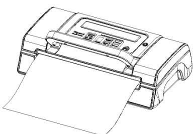
Drücken Sie den Griff wieder nach oben, öffnen Sie den Deckel und entnehmen Sie den Beutel. Dieser kann nun zum Vakuumieren benutzt werden.
