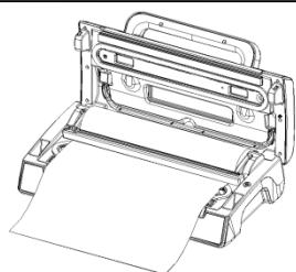
Ziehen Sie den Cutter dann mit festem Druck zur anderen Seite, um den Beutel zu schneiden.
