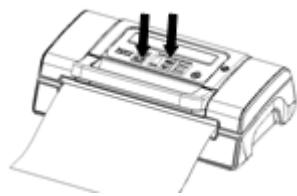
„Abbrechen“). De display telt af en er wordt automatisch lucht afgezuigd. Ten slotte wordt het zakje geseald, waarbij het controlelampje "handmatig lassen" (Manual Seal) gaat branden en de display weer aftelt tot 0.
