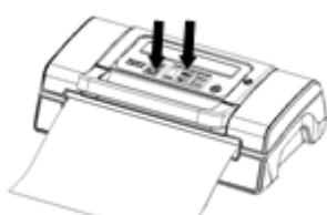
Pulse "Vacío y sellado".("Vakuum & Schweißen" / „Abbrechen“.). La pantalla realiza la cuenta atrás y se evacúa aire automáticamente. Finalmente se sella la bolsa mientras se ilumina el piloto indicador "**Sell manual**" (Schweißen) y la pantalla inicia la cuenta atrás hasta 0.
