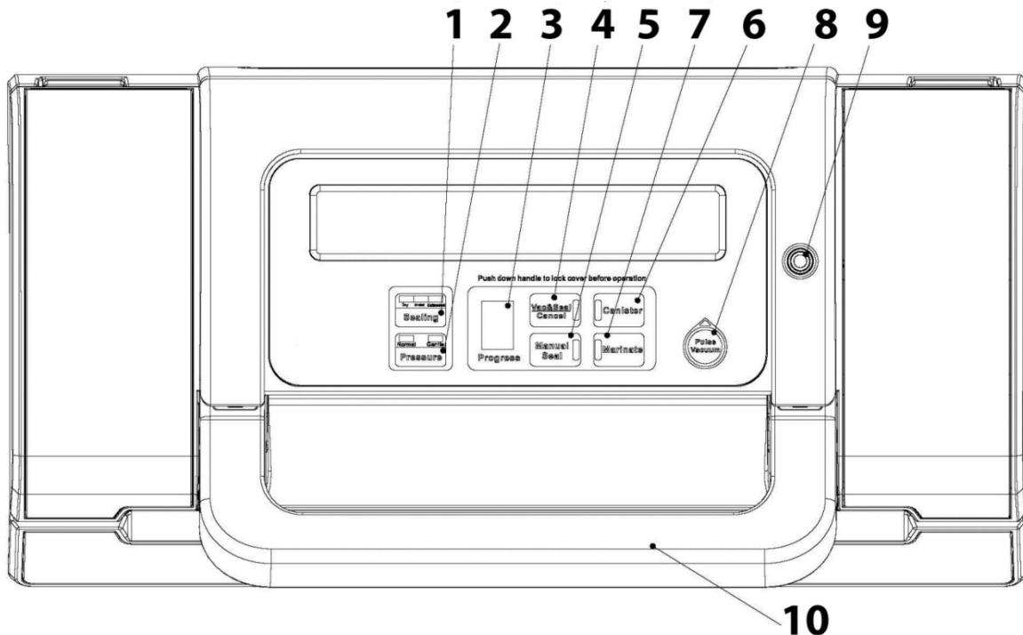
**9 Aansluiting voor vacuümslang:** Om een vacuümslang aan te sluiten voor het vacumeren van vacuümbakken en vacuin.
