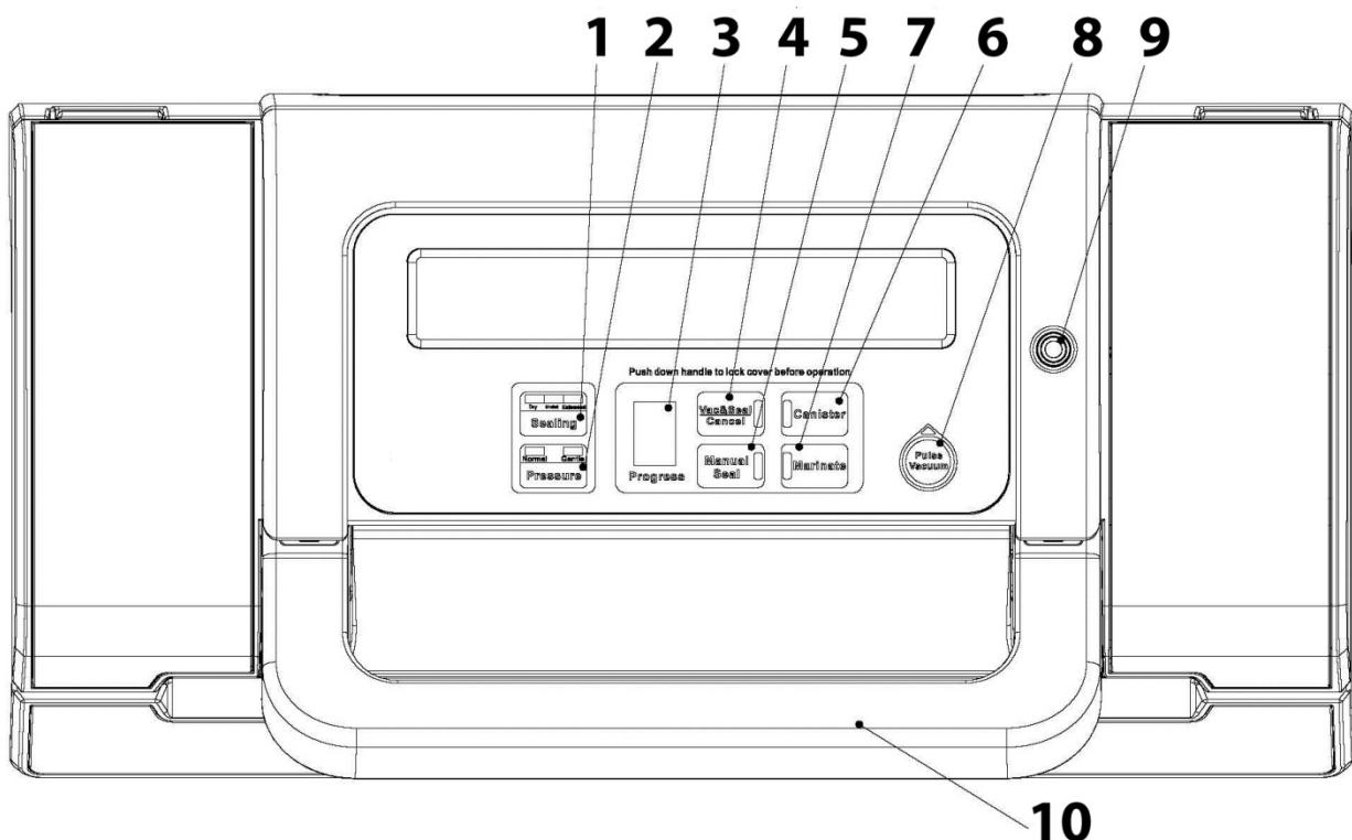
**9 Vakumschlauch-Anschluss:** Zum Anschluss eines Vakumschlusses für das Vakuumieren von Vakuumbehältern oder Weinstopfen.
