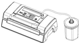
Füllen Sie das Vakuumiergut in den Behälter. Achten Sie darauf nicht zu viel Vakuumiergut einzufüllen. Verschließen Sie den Deckel.
