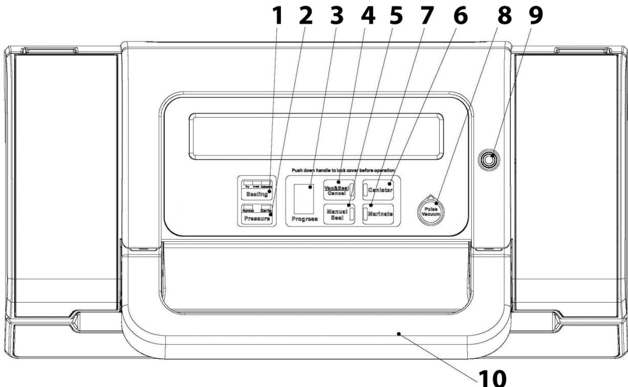
**9 Attacco del tubo flessibile per vuoto:** Per il collegamento di un tubo flessibile per vuoto per la messa sotto vuoto di contenitori per vuoto o tappi di vino.
