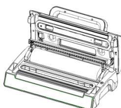
Let erop, dat de cutter voor het snijden aan de kant van de cutter-houder staat en klap vervolgens de cutter-houder naar boven.
