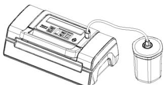
Fije un extremo del tubo flexible de vacío a la conexión del aparato y otro extremo a la conexión de la tapa del recipiente.
